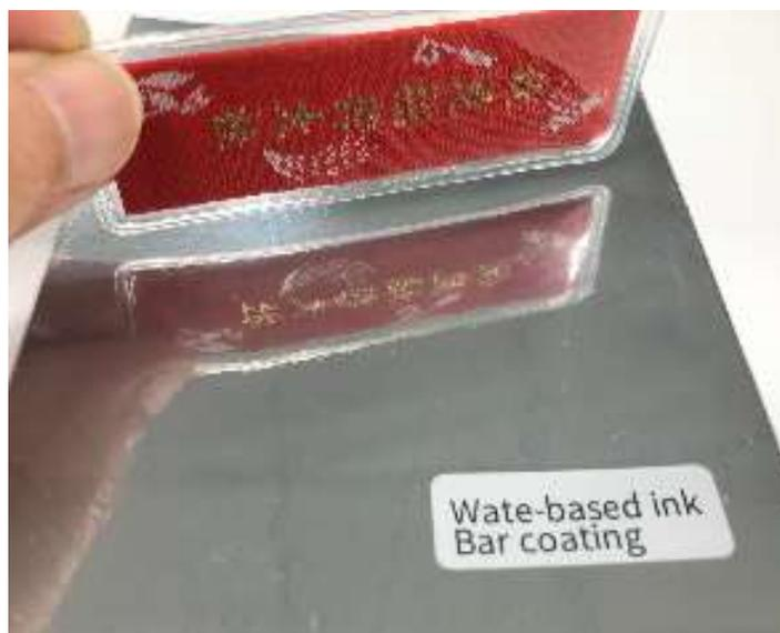
水系インクによるバーコード印刷サンプル
