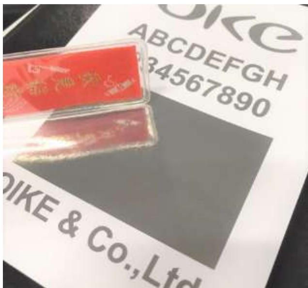
リーフパウダー® In 溶剤系インクによるインクジェット印刷サンプル
