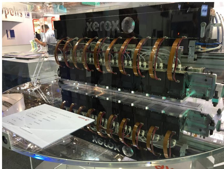
XEROX から導入したヘッドユニット(=IMPIKA による PANASONIC ヘッドユニット)
