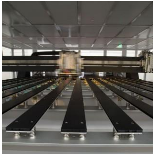
米国 Kateeva 社の有機 EL パネル製造装置
